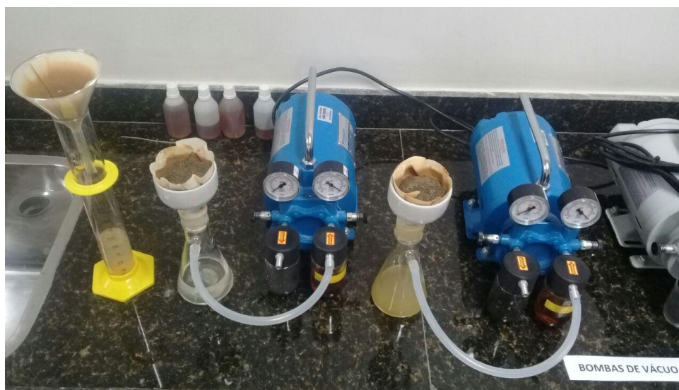
Figura 1 – Método de obtenção do extrato solúvel. (Fonte: Própria, 2017).
