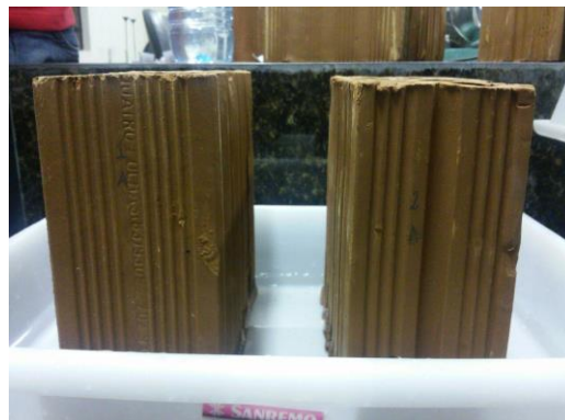
Figura 2 – Blocos imersos em água destilada
