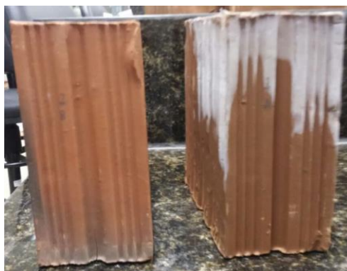
Figura 5 – Eflorescência de cor branca no bloco 2A em comparação ao bloco 2B (Fonte: Autores, 2017)
