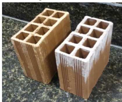
Figura 4 – Eflorescência de cor branca no bloco 1A em comparação ao bloco 1B (Fonte: Autores, 2017)
