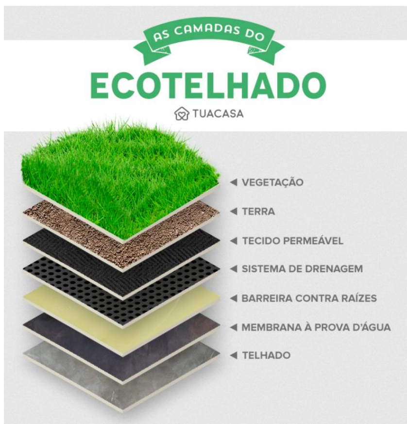
FIGURA 25 - Camadas do telhado verde
