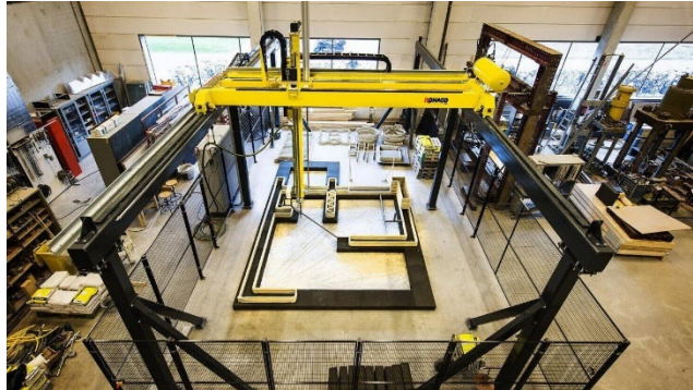
Figura 1. Exemplo de impressora 3D baseada na extrusão de concreto
