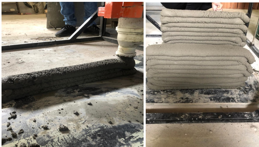
Figura 5. Impressão dos compósitos para construção de peças e medição da construtibilidade
