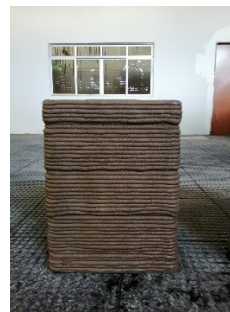
b) mini-parede 3DCP em construção e construída no IFPB
