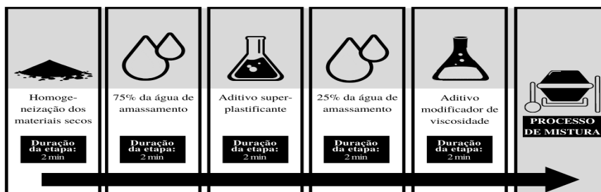
Figura 3. Esquematização do processo de mistura dos compósitos 3DCP
