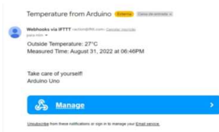
Figura 14: Resultado do monitoramento do dispositivo via IFTTT
