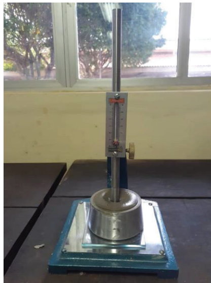
Figura 6 – Ensaio da consistência da pasta cimentícia
