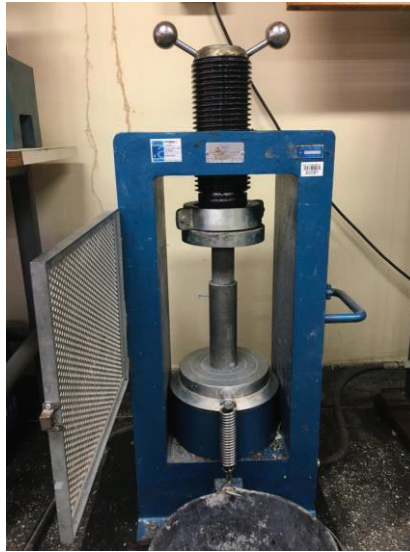
Figura 10 – Corpo de prova na prensa para aferir a resistência axial.
