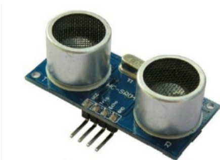
Figura 4. sensor ultrassônico HC-SR04 (Cytron, 2023).
